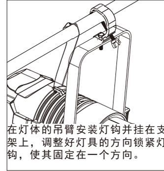
在灯体的吊臂安装灯钩并挂在支架上, 调整好灯具的方向锁紧灯钩, 使其固定在一个方向。
