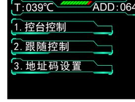
1. 在主菜单界面旋转【D】键选择【DMX选择】进入二级界面；旋转【D】键选择子菜单【控台控制】【跟随控制】【地址码设置】，选定后按B键可以跳至相应的页面。
