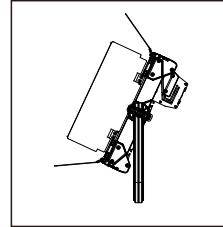
附件遮光叶只要同时向外施力即可向上翻开附件中的遮光叶, 将遮光叶挡片打开一定的角度, 起到遮光的作用。
