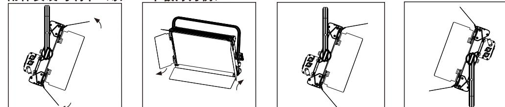
附件遮光叶只要同时向外施力即可向上翻开附件中的遮光叶, 将遮光叶挡片打开一定的角度, 起到遮光的作用。
